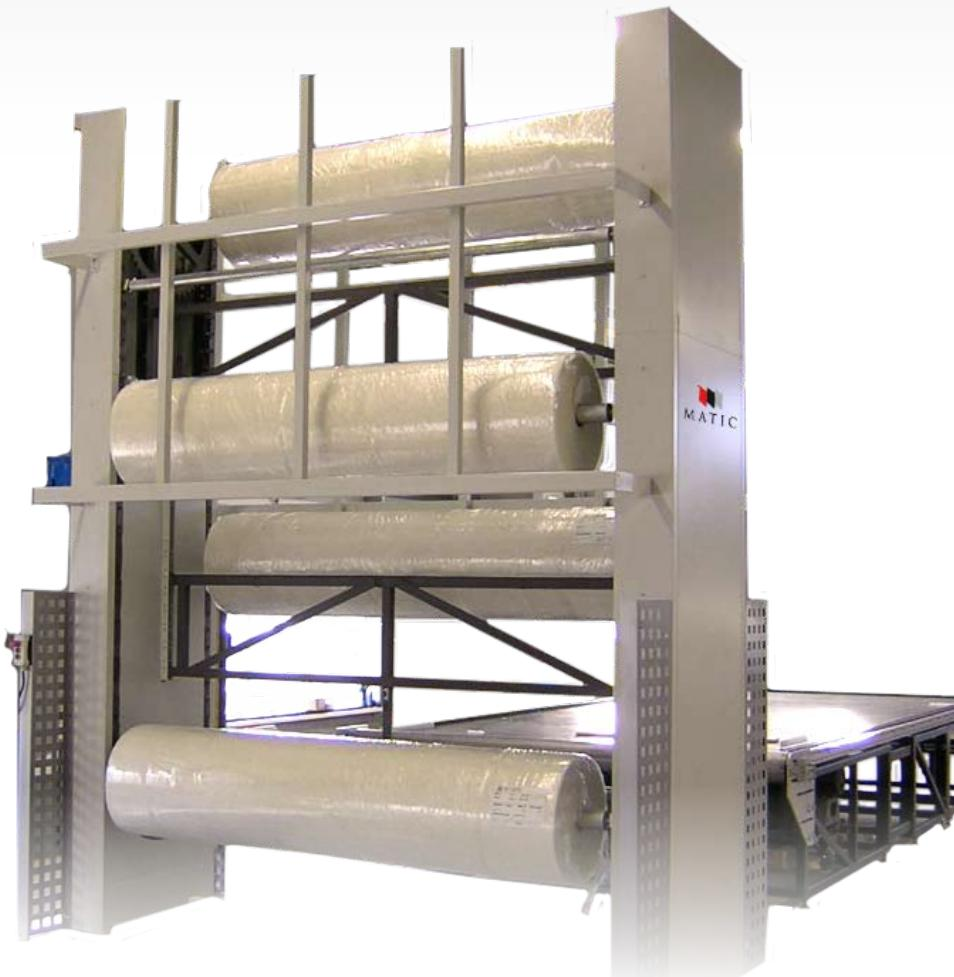
**Almacén de rollos vertical para optimizar el espacio, conseguir una manipulación más rápida y almacenar las bobinas de manera que no resulten dañadas.**
