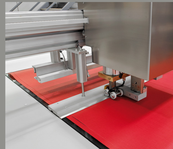
Press bar of the textile during cutting / Sistema de fijación del tejido durante el corte
